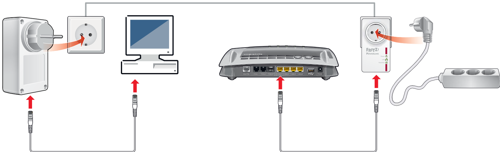
Réseau CPL établi à l'aide du kit FRITZ!Powerline 530E Set
